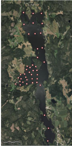
Bildet 2: Bildet viser Aremarksjøen med et oppsett av lyttebøyer. Blir fisken registrert ved flere bøyer kan man beregne posisjonen av fisken.
